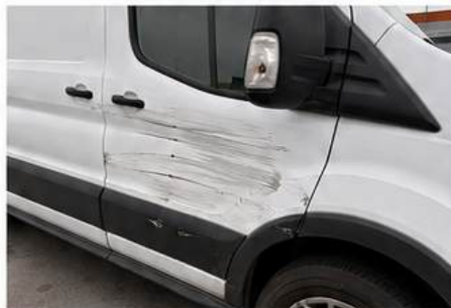
Foto č. 3 – detail poškození předních dveří spolujezdce
